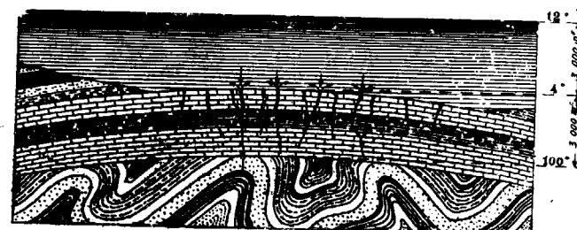
Fig. 5.<sup>a</sup> — Génesis de un yacimiento metasomático en posición anticlinal.
